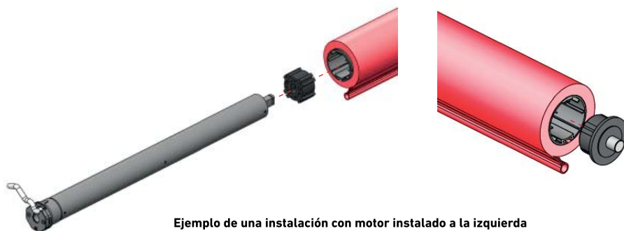
Ejemplo de una instalación con motor instalado a la izquierda
